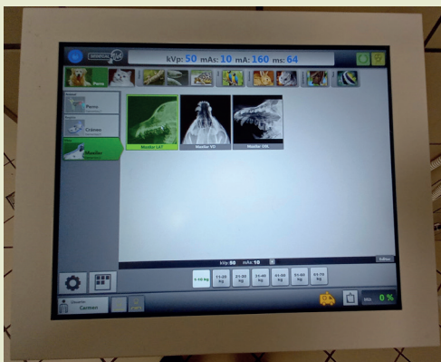
FIGURA 18 Console de controle digital, no qual parâmetros de exposição são selecionados usando um programa de computador, por meio de uma tela sensível ao toque (touch screen).
