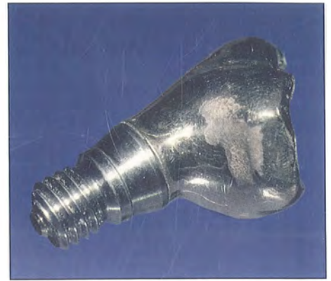
Fig. 8-31 A fratura no implante resultou da sobrecarga em função do cantiléver excessivo.
