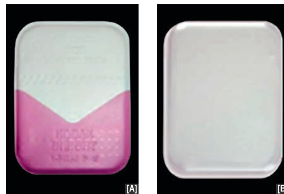
05. [A,B] As duas faces do filme radiográfico periapical: face de não exposição [A]; face de exposição [B].
