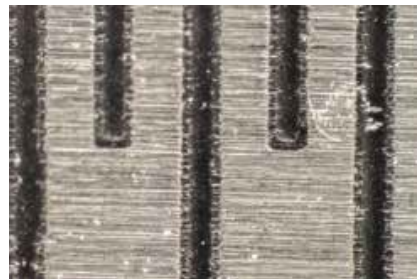
Figura 11.13: Magnificação de uma régua metálica com a Objetiva CFI Plan 10x acoplada a uma teleobjetiva de 200mm em um Sensor APS-C (Imagem sem corte). Taxa de Magnificação 10x.
