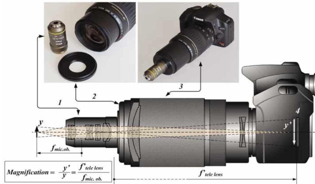
Figura 11.12: Esquema óptico de macrofotografia usando uma objetiva de microscópio infinita Nikon CFI 10x acoplada a uma teleobjetiva intermediária. (Fonte: http://www.photomacrography.net )
