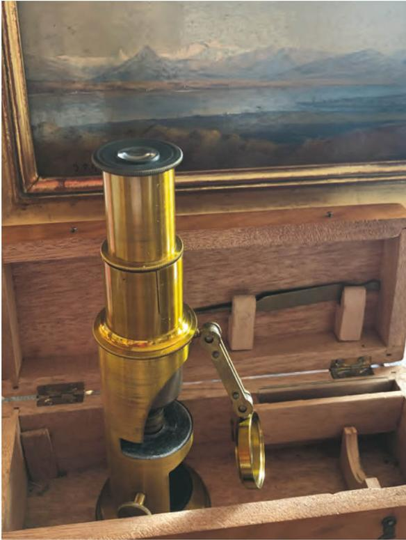
**Figura 1.3** Antigo microscópio de latão do final de 1800 com lâminas de vidro originais em caixa de madeira (do acervo pessoal do autor).
